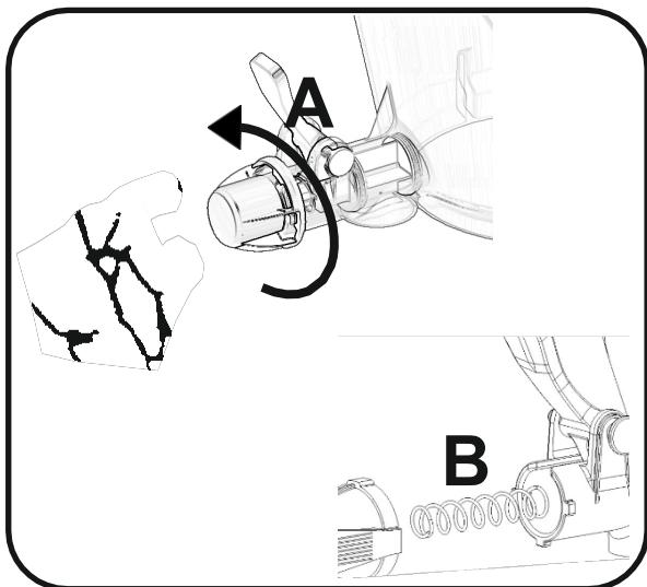
**SK** Prvým krokom pri demontáži kohútika je odstránenie uzáveru otáčaním proti smeru hodinových ručičiek, aby sa uvoľnil z bajonetového spoja so zubami na nádrži.
